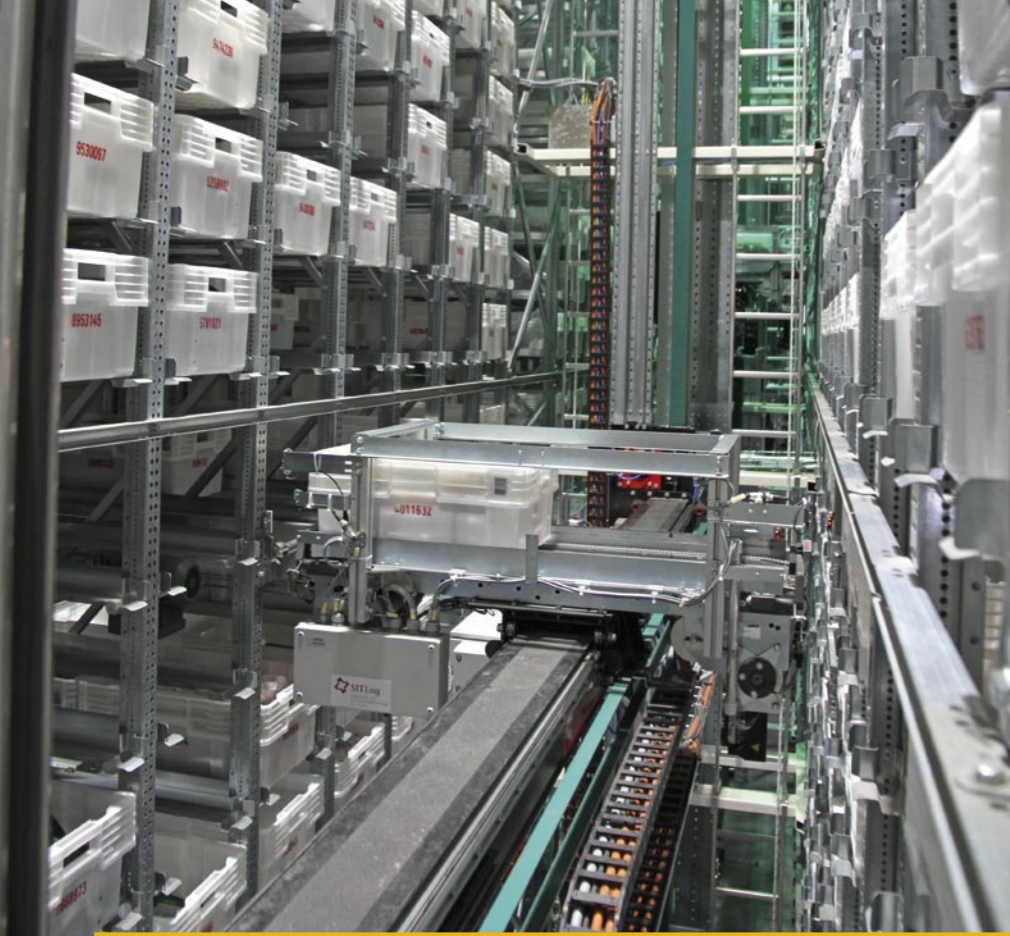
De snelle commissioners verzorgen niet alleen de inslag van voorraadbakken en de aanvulling van de picklocaties, maar ook de in- en uitslag van klantenbakken.
